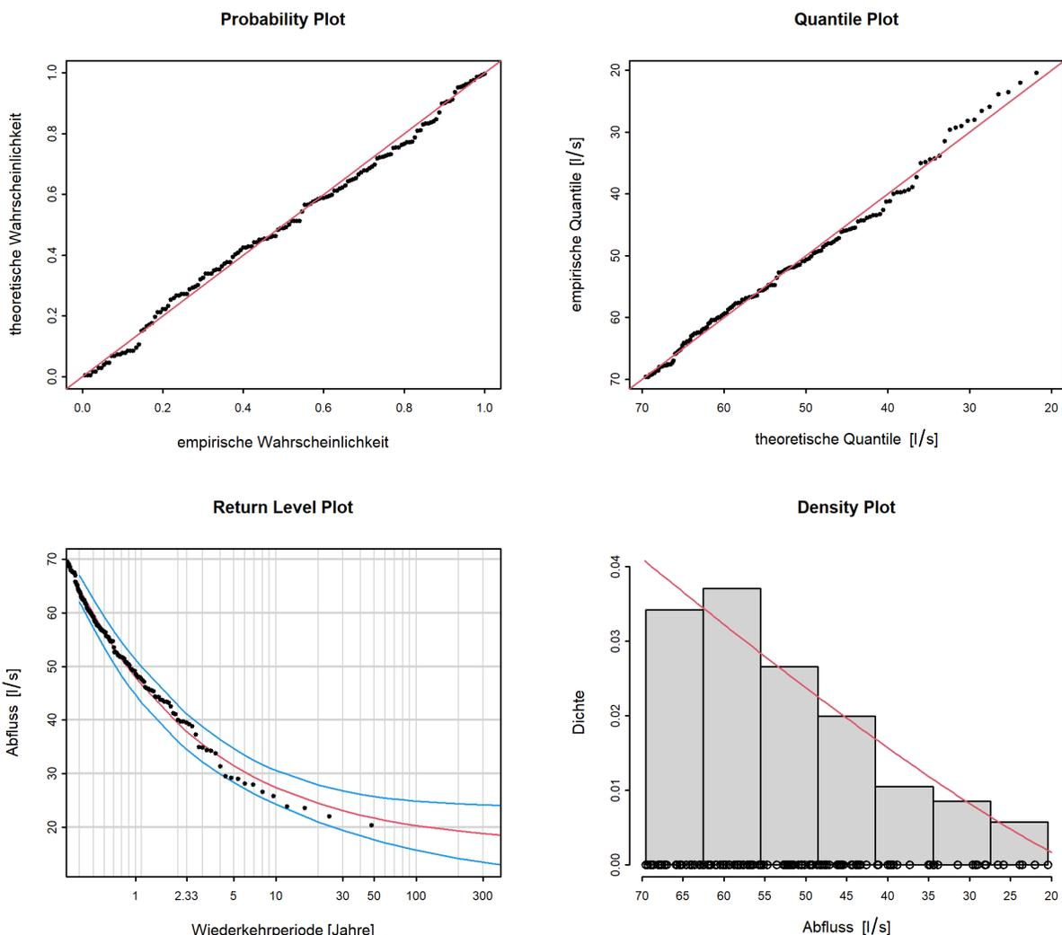
Abbildung 9: Diagnostikplots der Modellvariante "stat" des POT-Ansatzes (01.04.1972 - 31.03.2020)
