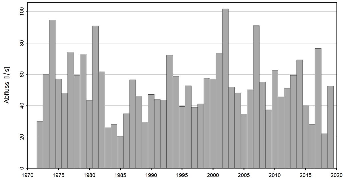
Abbildung 6: Zeitreihe der NM7Q [l/s] (01.04.1972 - 31.03.2020)
