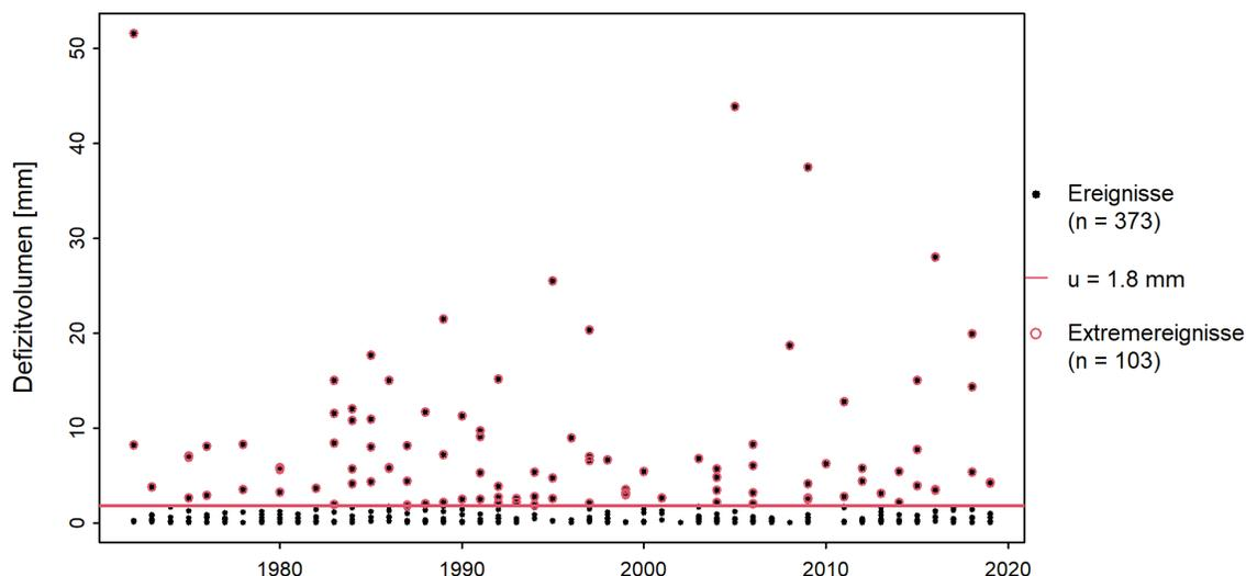
Abbildung 13: Auswahl der für den POT-Ansatz verwendeten Defizitvolumen-Extremereignisse
