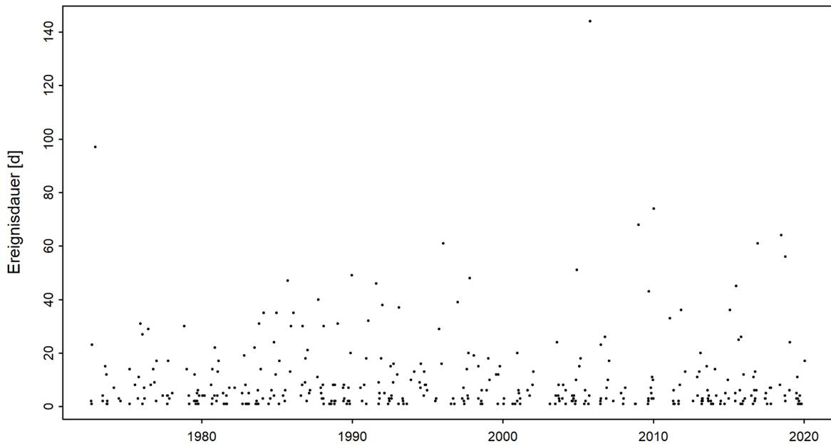
Abbildung 4: Zeitreihe der Niedrigwasserdauern [d] (01.04.1972 - 31.03.2020)
