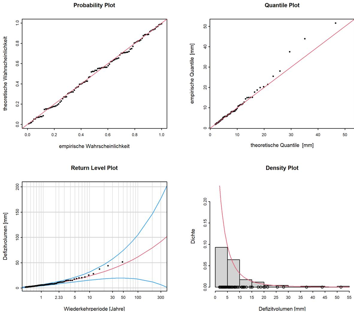
Abbildung 14: Diagnostikplots der Modellvariante "stat" des POT-Ansatzes (01.04.1972 - 31.03.2020)
