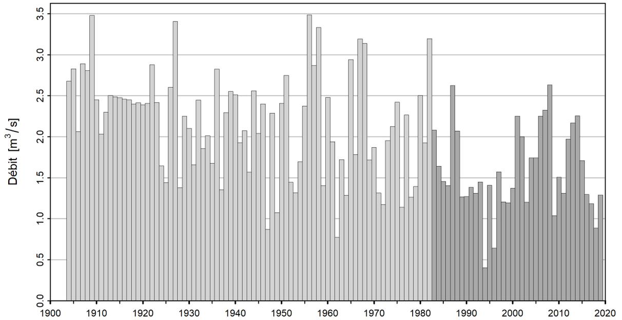
FIGURE 6 – Série temporelle de NM7Q [ $\text{m}^3/\text{s}$ ] (01.04.1904 - 31.03.2020), gris clair : NM7Q non utilisés, gris foncé : NM7Q utilisés
