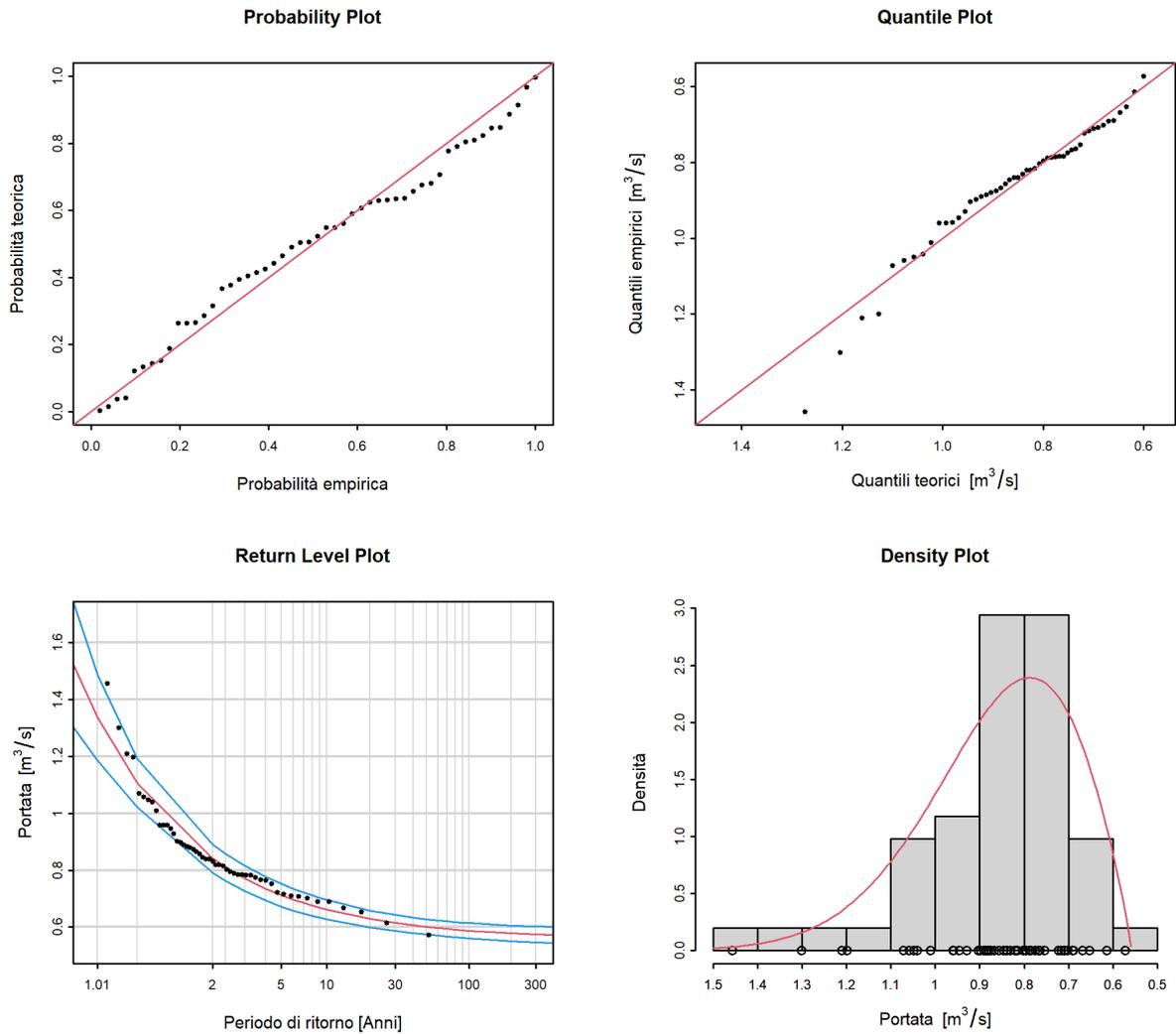
Figura 7: Plot diagnostici della variante di modello "stat" dell'approccio BLOCK (01.06.1968 - 31.05.2019)
