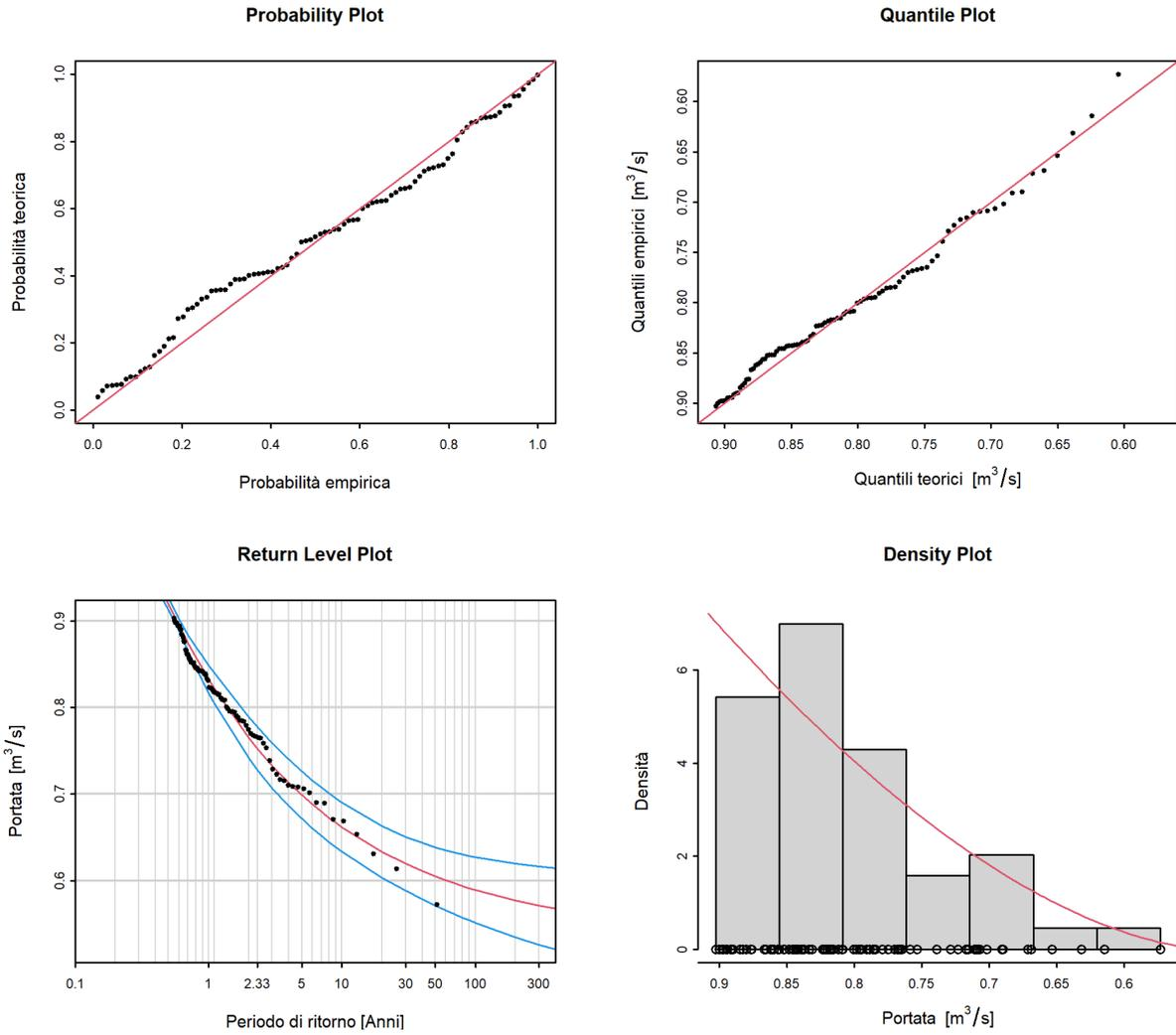
Figura 9: Plot diagnostici della variante di modello "stat" dell'approccio POT (01.06.1968 - 31.05.2019)
