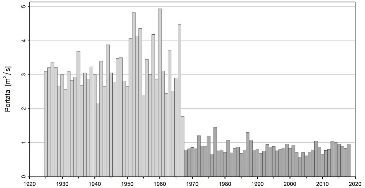
Figura 6: Serie temporale di NM7Q [ $\text{m}^3/\text{s}$ ] (01.06.1925 - 31.05.2019), grigio chiaro: NM7Q non utilizzati, grigio scuro: NM7Q utilizzati
