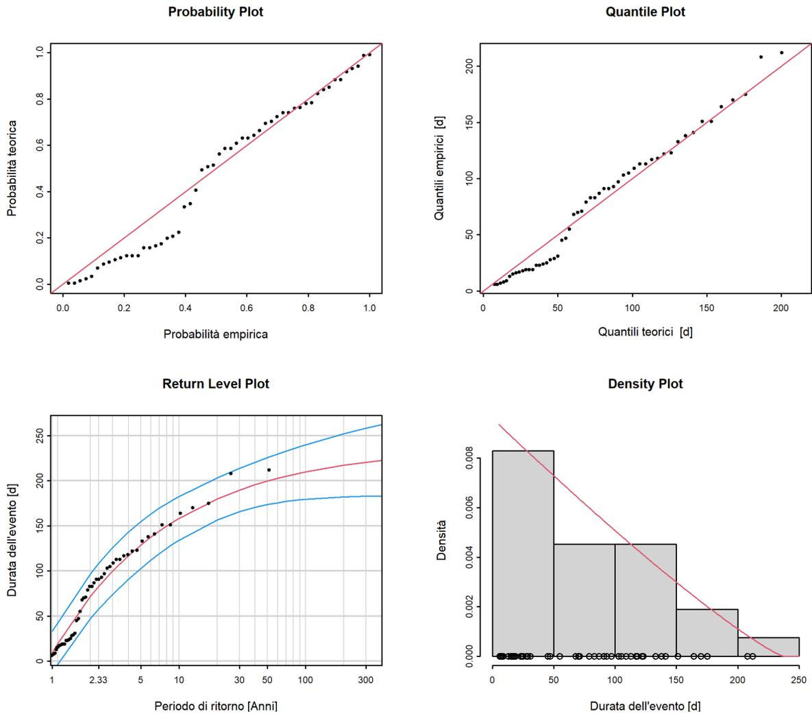
Figura 12: Plot diagnostici della variante di modello "stat" dell'approccio POT (01.06.1968 - 31.05.2019)
