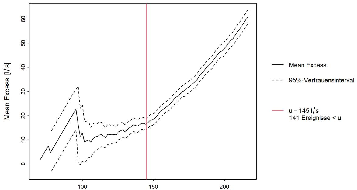
Abbildung 15: “mean residual life plot” für Niedrigwasserabfluss
