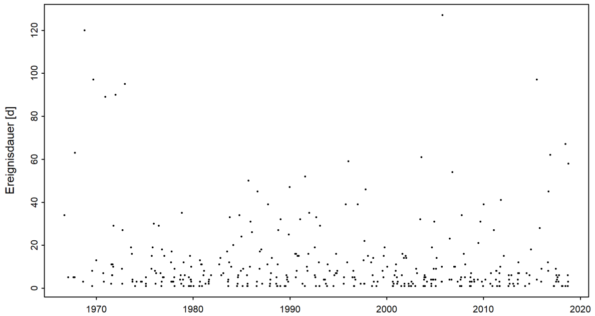
Abbildung 4: Zeitreihe der Niedrigwasserdauern [d] (01.04.1966 - 31.03.2019)
