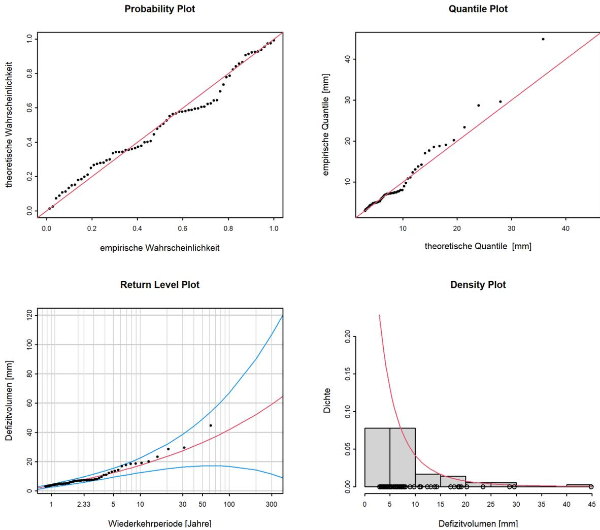
Abbildung 14: Diagnostikplots der Modellvariante "stat" des POT-Ansatzes (01.04.1958 - 31.03.2020)
