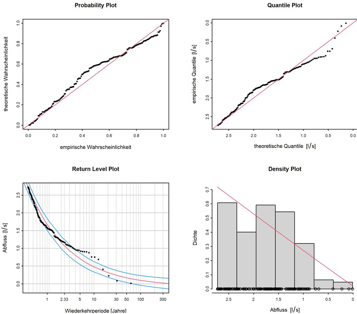
Abbildung 9: Diagnostikplots der Modellvariante "stat" des POT-Ansatzes (01.04.1958 - 31.03.2020)
