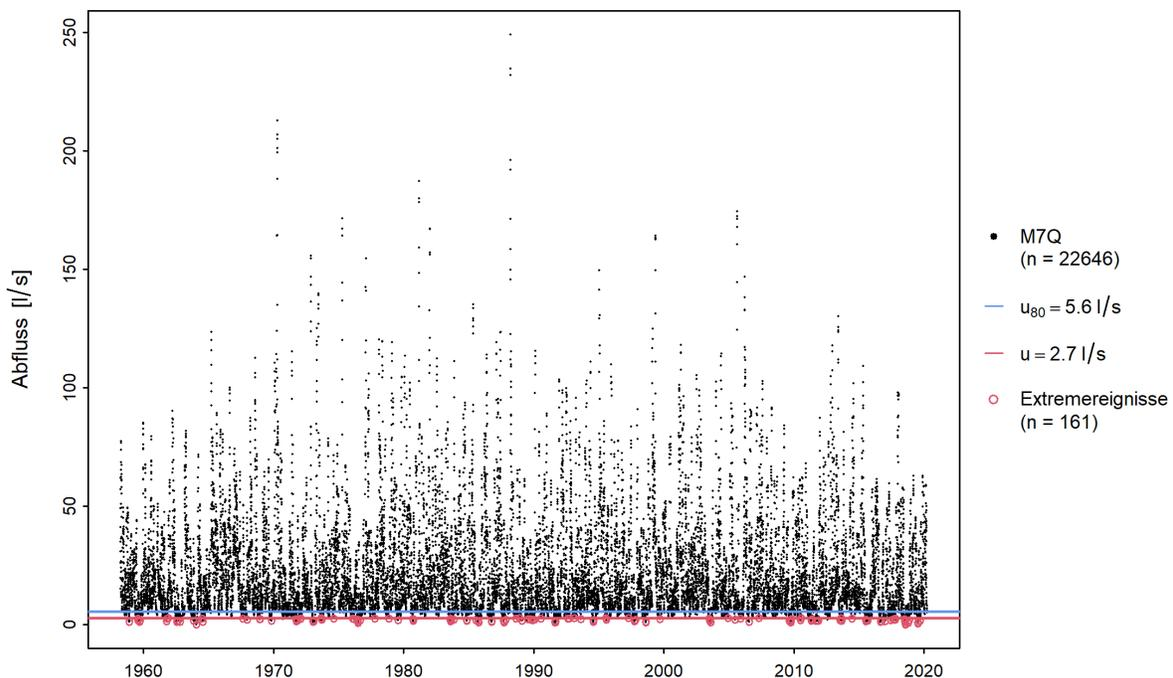
Abbildung 8: Auswahl der für den POT-Ansatz verwendeten Extremereignisse
