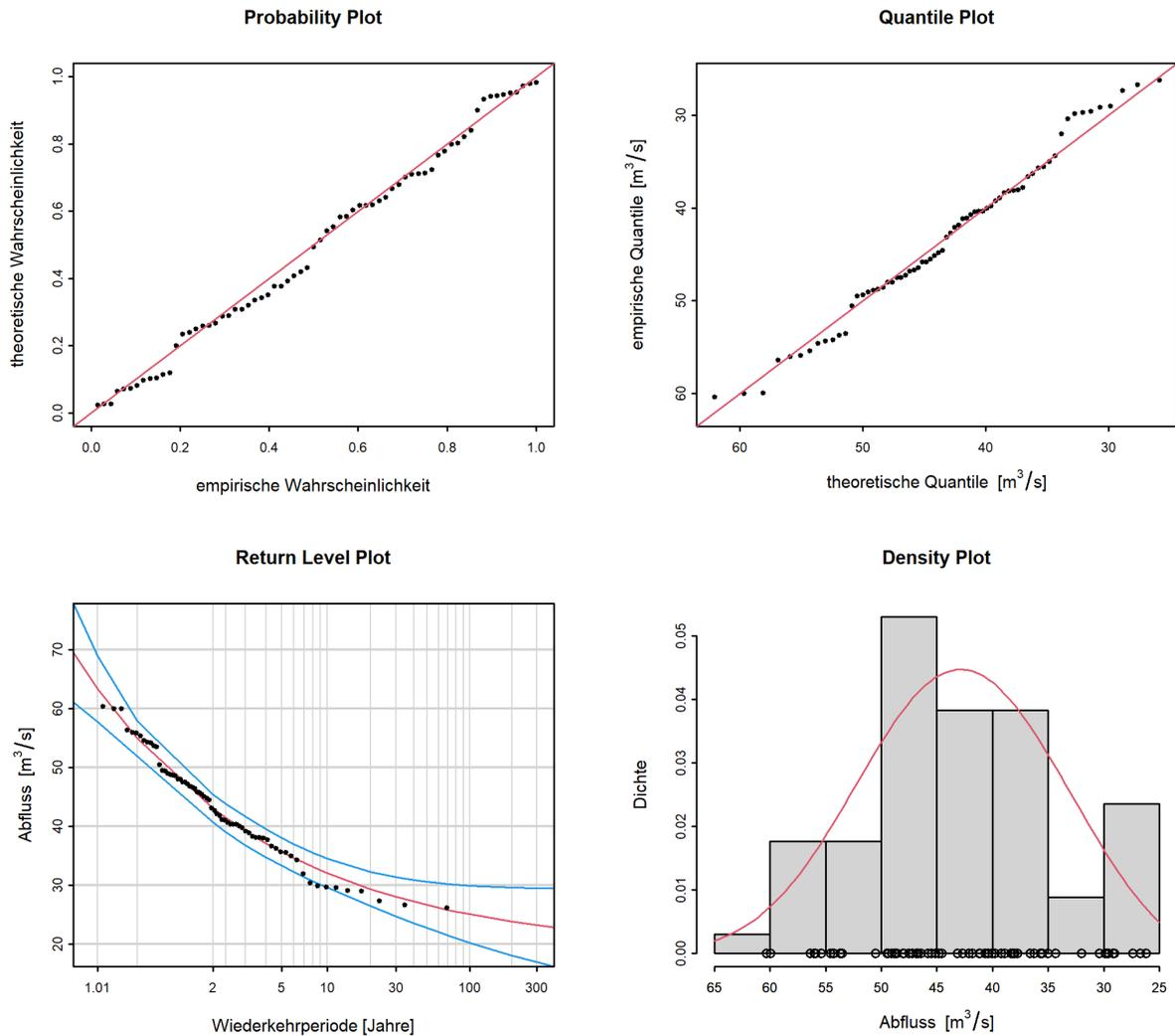
Abbildung 7: Diagnostikplots der Modellvariante “stat” des BLOCK-Ansatzes (01.06.1951 - 31.05.2019)
