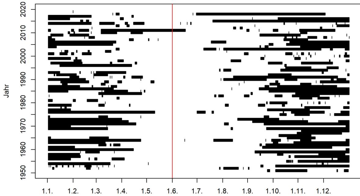
Abbildung 1: Zeitliches Auftreten der Niedrigwasserperioden im Jahresverlauf (01.06.1951 - 31.05.2019) und Startmonat des Niedrigwasserjahres (rote Linie)<sup>1</sup>
