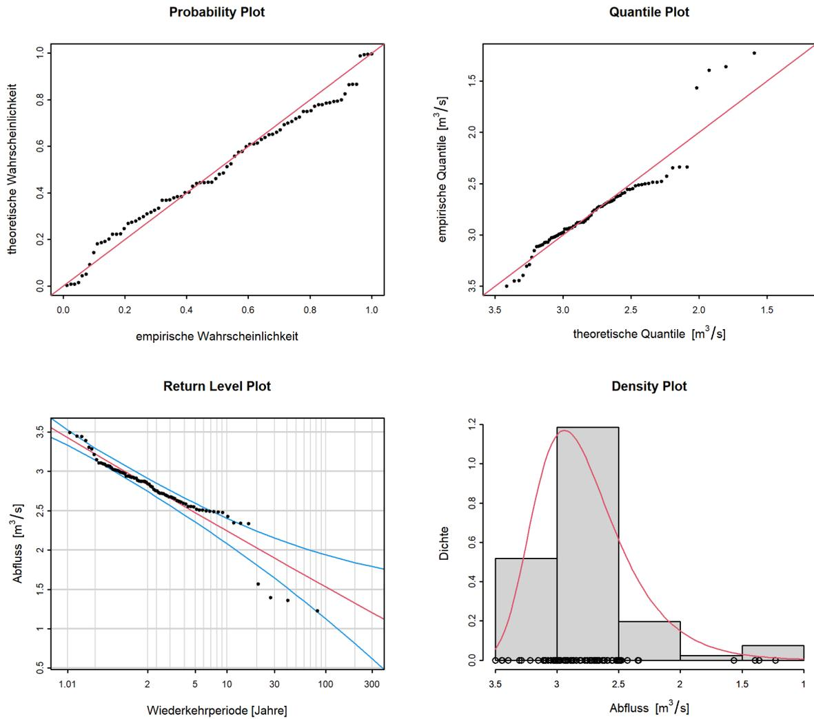
Abbildung 7: Diagnostikplots der Modellvariante "stat" des BLOCK-Ansatzes (01.04.1938 - 31.03.2019)
