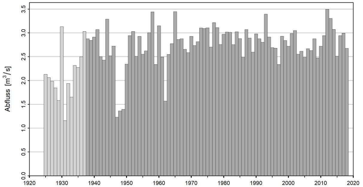
Abbildung 6: Zeitreihe der NM7Q [ $\text{m}^3/\text{s}$ ] (01.04.1925 - 31.03.2019), hellgrau: nicht verwendete NM7Q, dunkelgrau: verwendete NM7Q
