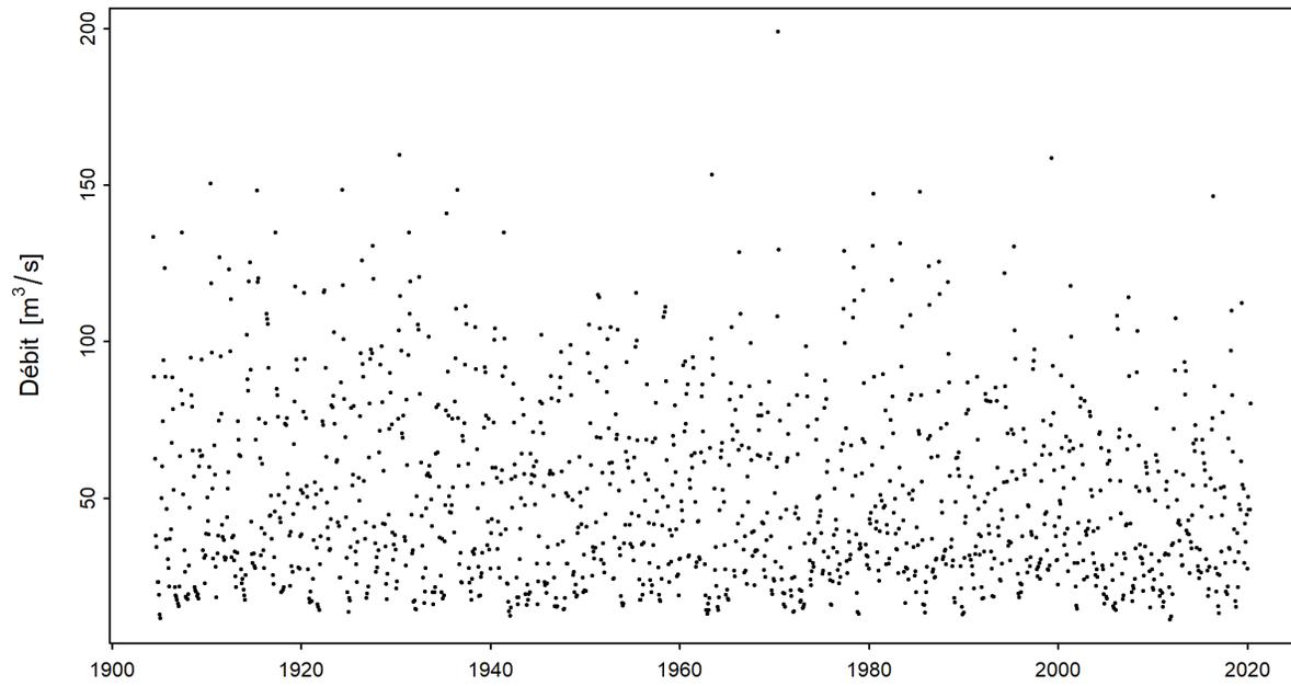
FIGURE 3 – Série temporelle du minimum mensuel de M7Q [ $\text{m}^3/\text{s}$ ] (01.06.1904 - 31.05.2020)
