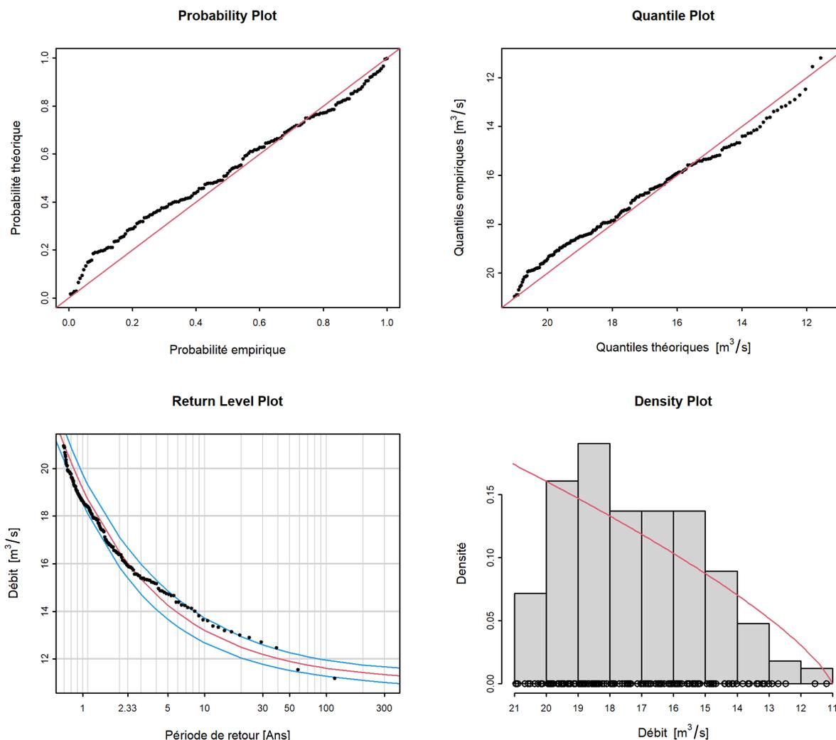
FIGURE 9 – Graphiques diagnostiques de la variante du modèle “ stat ” de la méthode POT (01.06.1904 - 31.05.2020)
