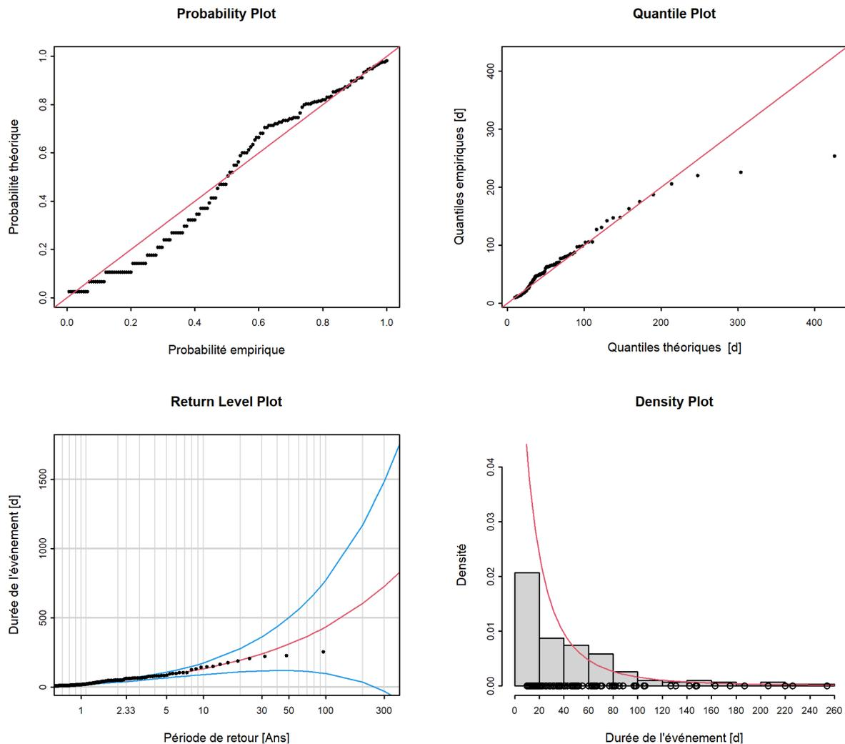
FIGURE 12 – Graphiques diagnostiques de la variante du modèle “ stat ” de la méthode POT (01.04.1925 - 31.03.2020)
