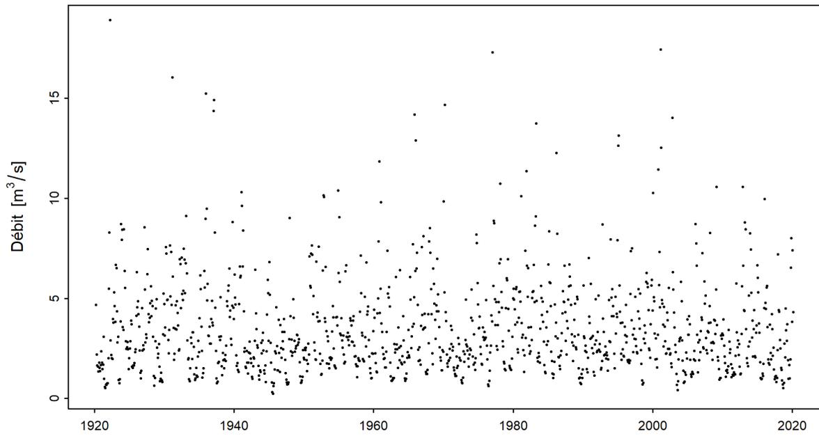
FIGURE 3 – Série temporelle du minimum mensuel de M7Q [ $\text{m}^3/\text{s}$ ] (01.04.1920 - 31.03.2020)
