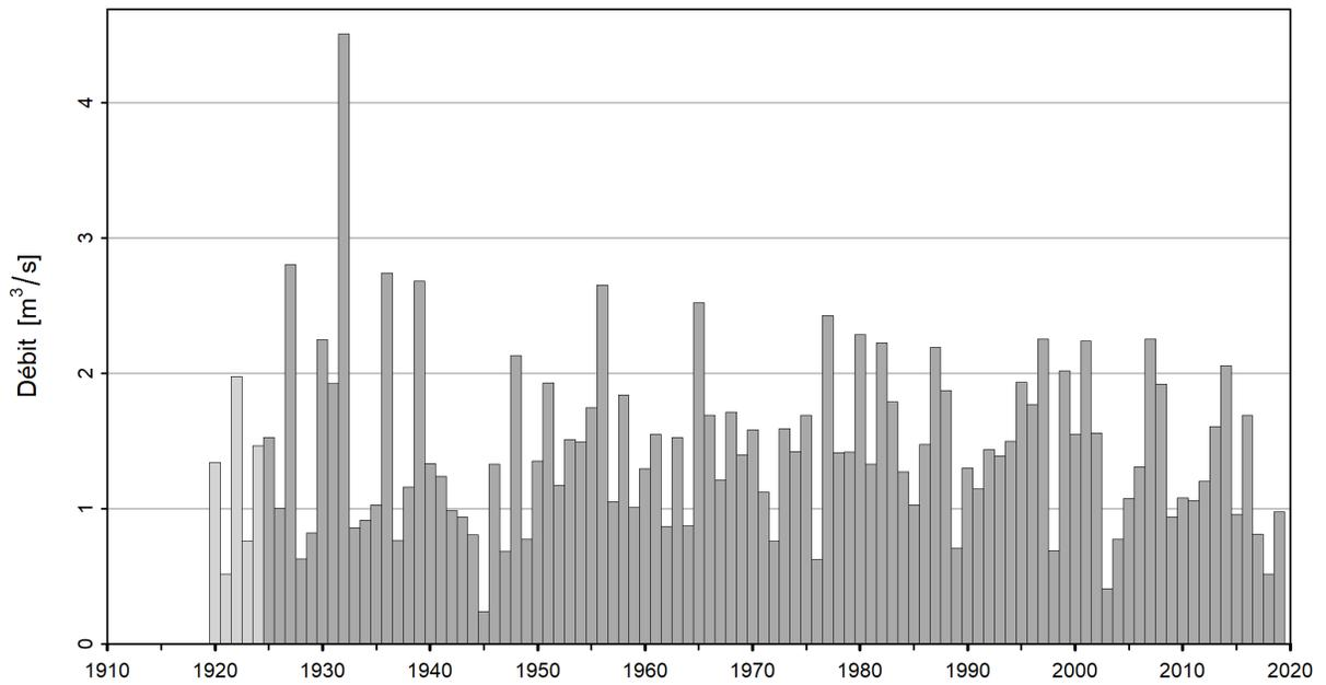
FIGURE 6 – Série temporelle de NM7Q [m<sup>3</sup>/s] (01.04.1920 - 31.03.2020), gris clair : NM7Q non utilisés, gris foncé : NM7Q utilisés
