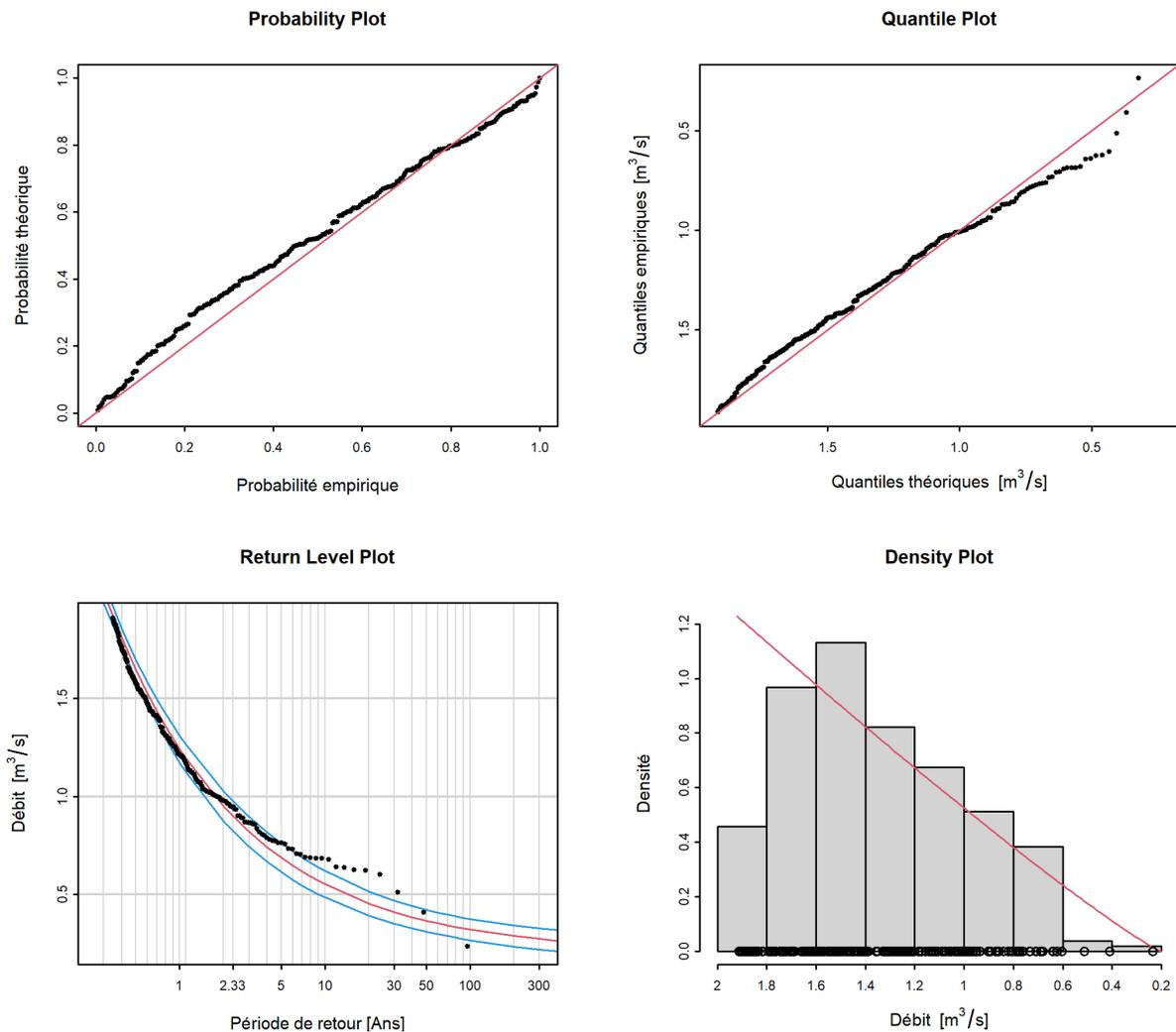
FIGURE 9 – Graphiques diagnostiques de la variante du modèle “ stat ” de la méthode POT (01.04.1925 - 31.03.2020)
