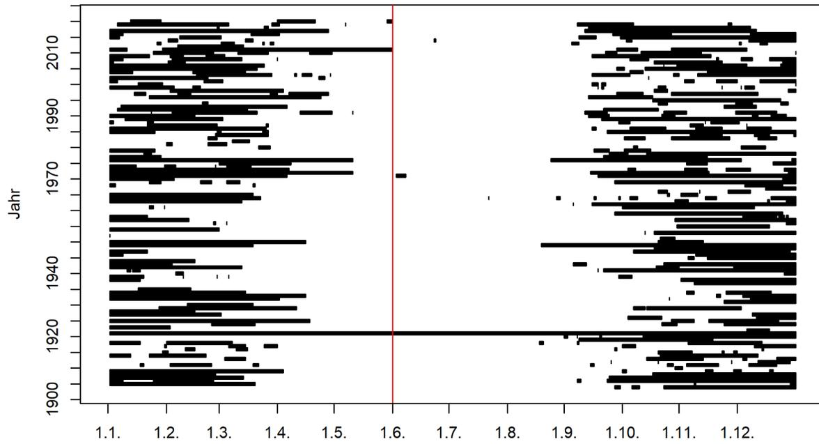
Abbildung 1: Zeitliches Auftreten der Niedrigwasserperioden im Jahresverlauf (01.06.1904 - 31.05.2020) und Startmonat des Niedrigwasserjahres (rote Linie)<sup>1</sup>
