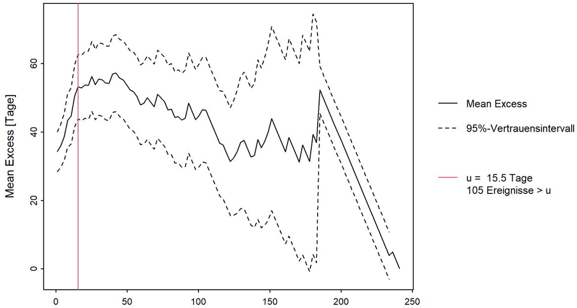
Abbildung 16: "mean residual life plot" für Niedrigwasserdauer
