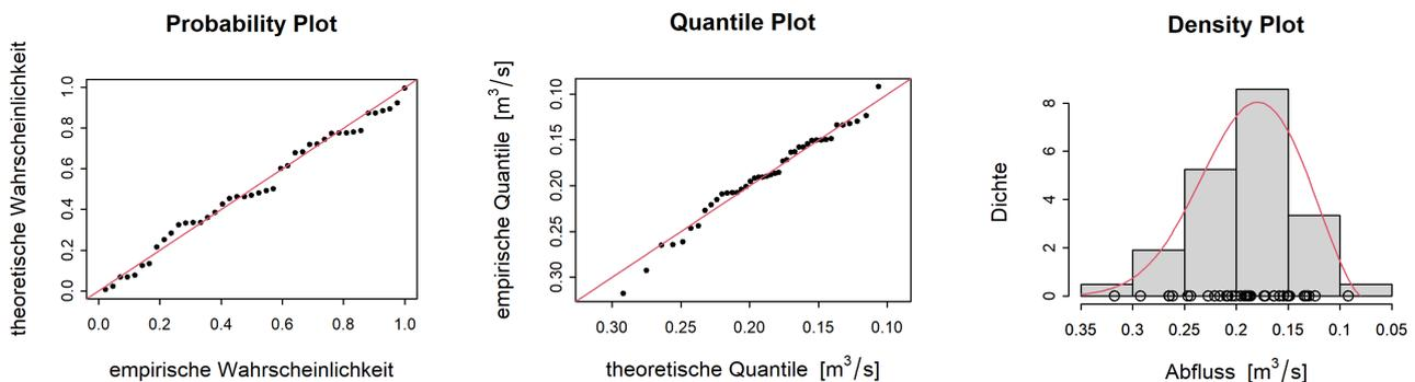
**Probability Plot:** Diagramm der empirischen vs. der theoretischen Wahrscheinlichkeiten. Die theoretischen Wahrscheinlichkeiten werden mit der modellierten GEV geschätzt. Würden die Punkte auf der Diagonalen (rote Linie) liegen, wäre der Fit perfekt.
