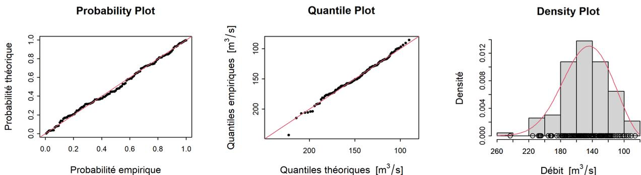
**Probability Plot :** Diagramme comparant les probabilités empiriques aux probabilités théoriques des observations, supposant que celles-ci proviennent de la GEV ajustée. Si l'ajustement était parfait, les points s'aligneraient sur la diagonale (ligne rouge).
