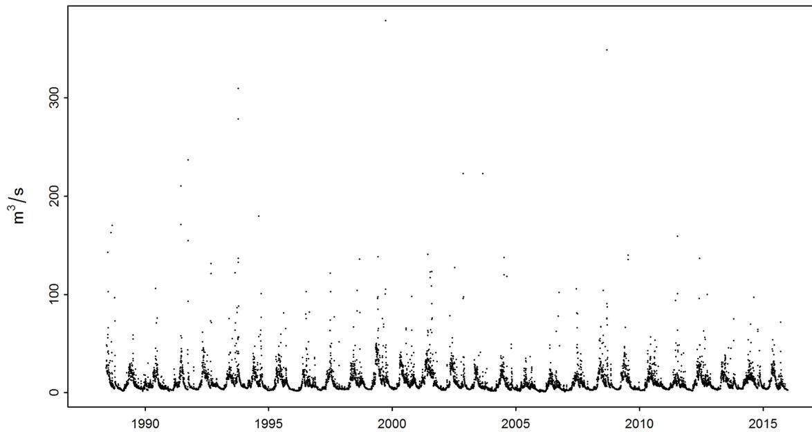
Abbildung 4: Zeitreihe der maximalen Tagesabflüsse [ $\text{m}^3/\text{s}$ ] (09.06.1988 - 31.12.2015)
