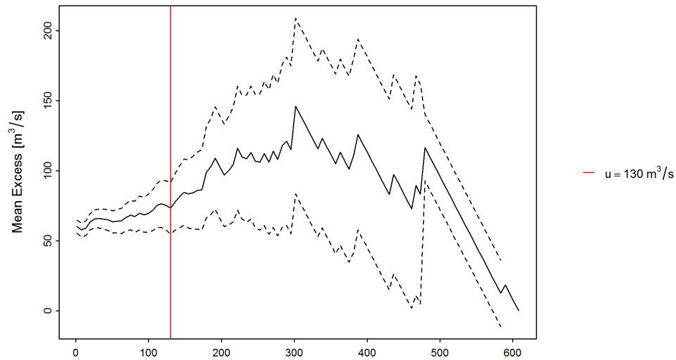
Abbildung 9: „mean residual life plot“ mit gewähltem Schwellenwert u (rote Linie) mean Excess (schwarze Linie), 95%-Konfidenzintervall (gestrichelte Linien)
