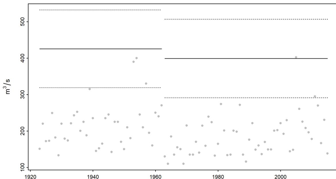
Abbildung 7: Veränderung der mit der Modellvariante „mujump1963“ berechneten HQ<sub>100</sub> (durchgezogene Linien) und des 95%-Konfidenzintervalls (Deltamethode; gestrichelte Linien) über die Jahre 1923-2015
