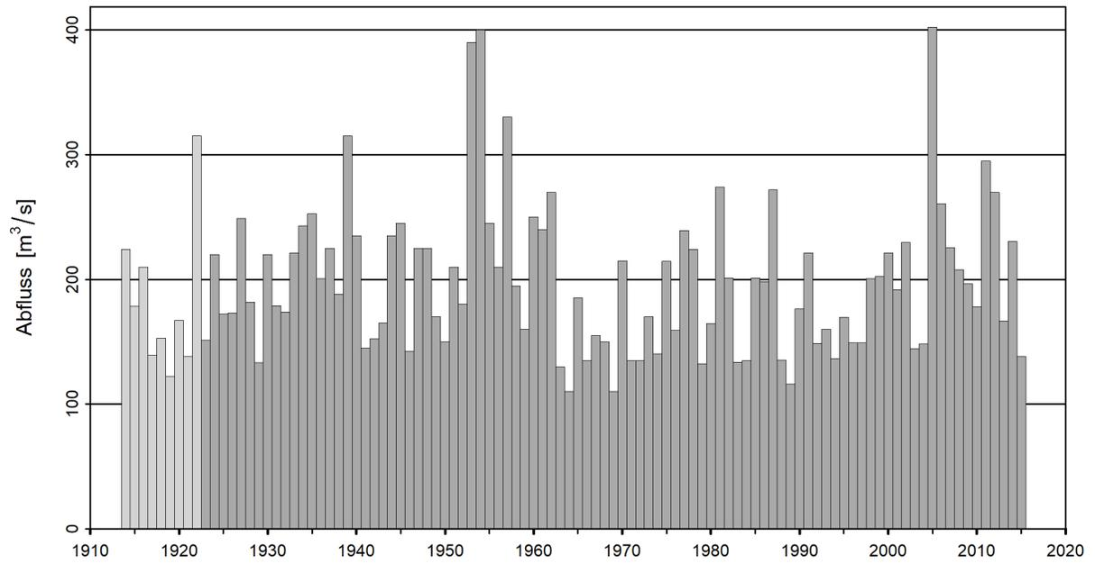
Abbildung 1: Zeitreihe der Jahresmaxima [m<sup>3</sup>/s] (1914 - 2015, hellgrau: nicht für die Statistik verwendete Jahresmaxima, dunkelgrau: verwendete Jahresmaxima der gesamten Auswertungsperiode ab Limnigrapheninstallation).
