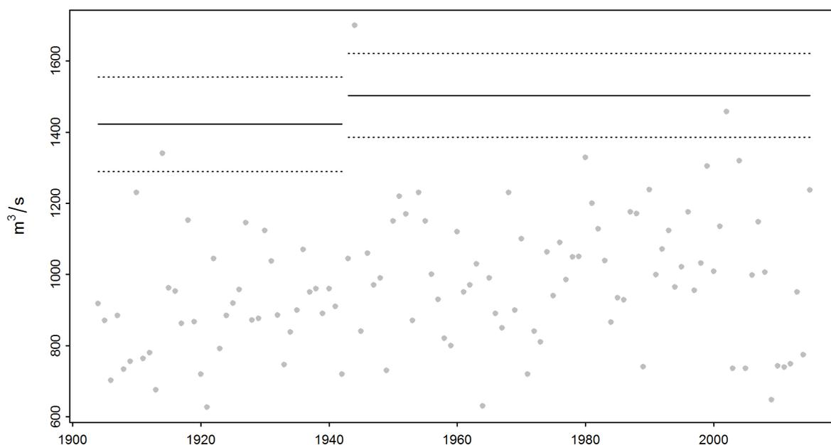
FIGURE 7 – Modification des HQ<sub>100</sub> (calculés à l'aide de la variante «mujump1943») et de l'intervalle de confiance à 95 % (méthode delta ; lignes en traitillé) durant la période 1904-2015
