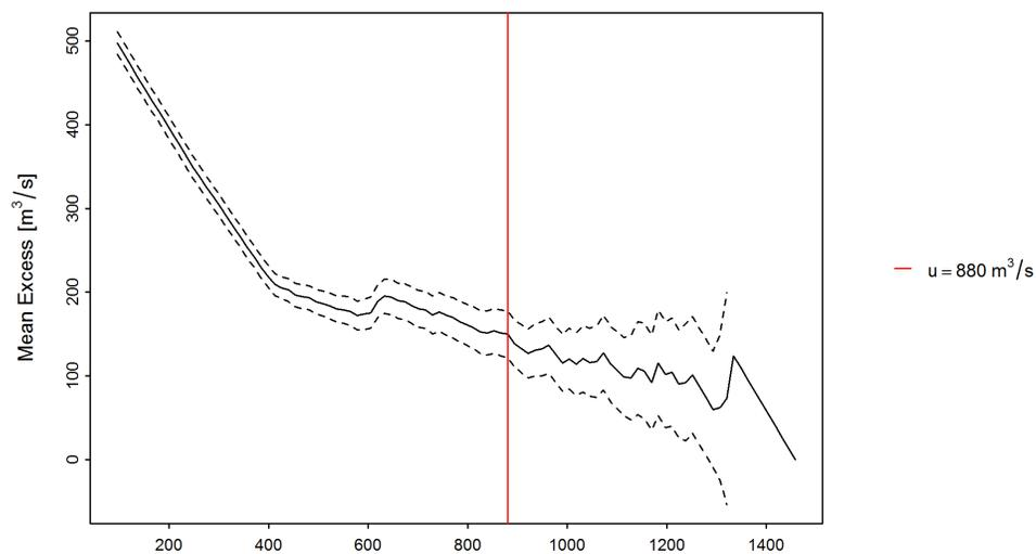
FIGURE 12 – «mean residual life plot» avec le seuil déterminé  $u$  (ligne rouge), dépassement moyen (ligne noire), intervalle de confiance à 95 % (traitillés)
