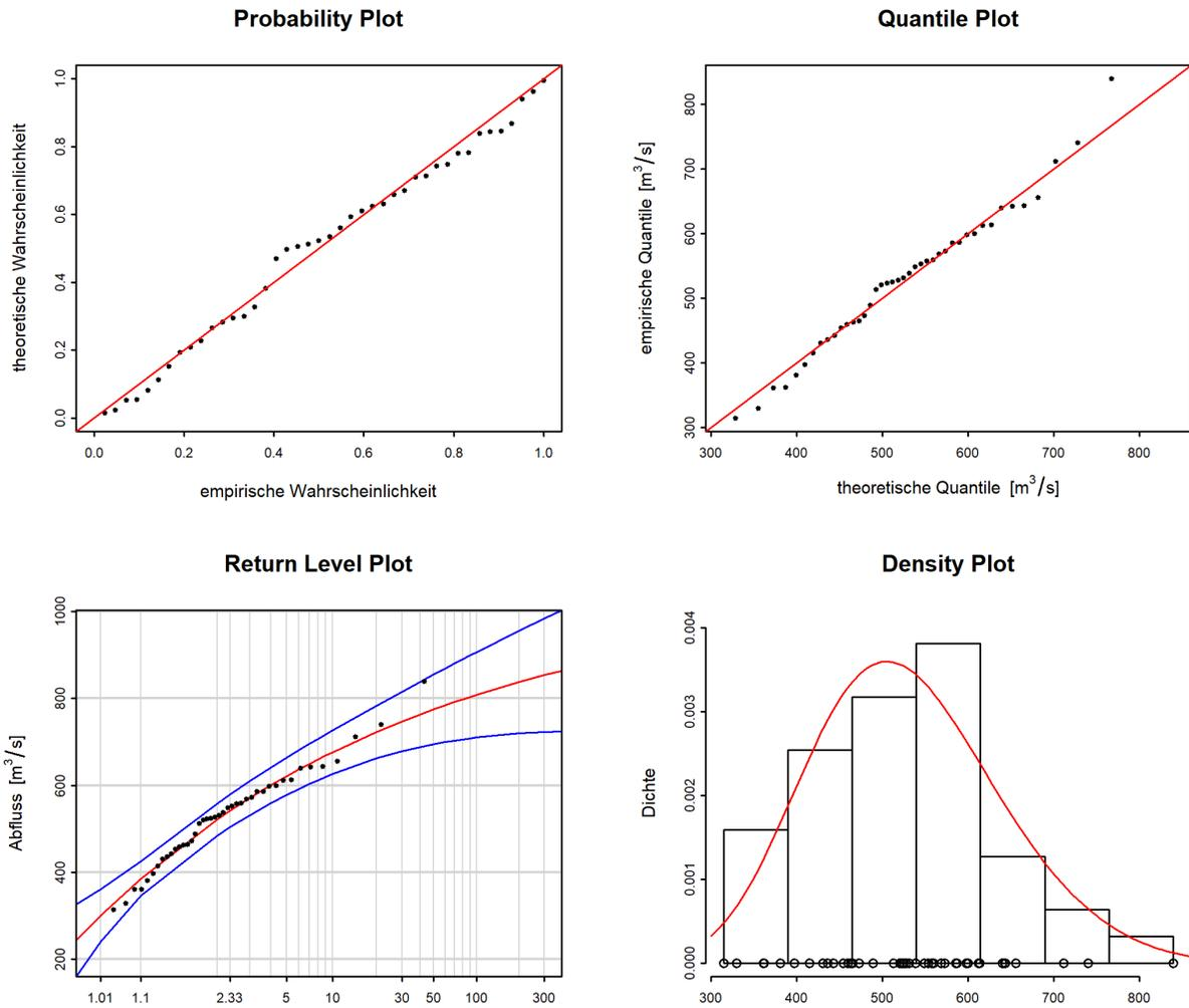
Abbildung 8: Diagnostikplots der Modellvariante „stat“ des BLOCK-Ansatzes (1974-2015)
