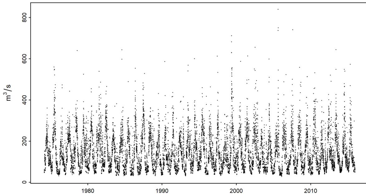
Abbildung 4: Zeitreihe der maximalen Tagesabflüsse [ $\text{m}^3/\text{s}$ ] (01.03.1974 - 31.12.2015)
