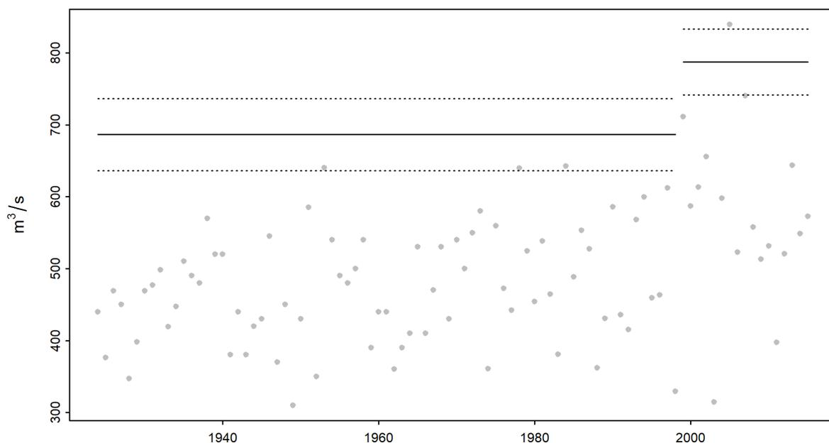
Abbildung 7: Veränderung der mit der Modellvariante „mujump1999“ berechneten HQ<sub>100</sub> (durchgezogene Linien) und des 95%-Konfidenzintervalls (Deltamethode; gestrichelte Linien) über die Jahre 1924-2015
