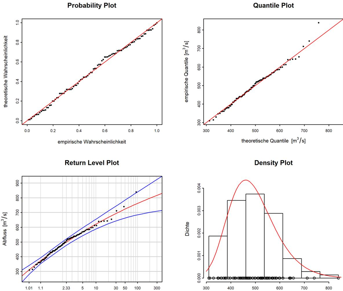
Abbildung 5: Diagnostikplots der Modellvariante „stat“ des BLOCK-Ansatzes (1924-2015)
