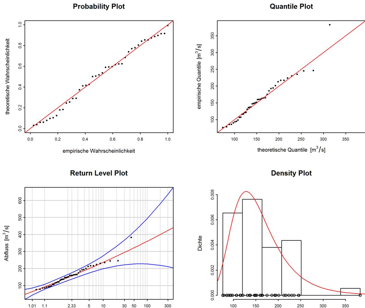
Abbildung 6: Diagnostikplots der Modellvariante „stat“ des BLOCK-Ansatzes (1974-2015)
