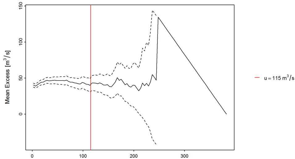
Abbildung 10: „mean residual life plot“ mit gewählttem Schwellenwert  $u$  (rote Linie) mean Excess (schwarze Linie), 95%-Konfidenzintervall (gestrichelte Linien)
