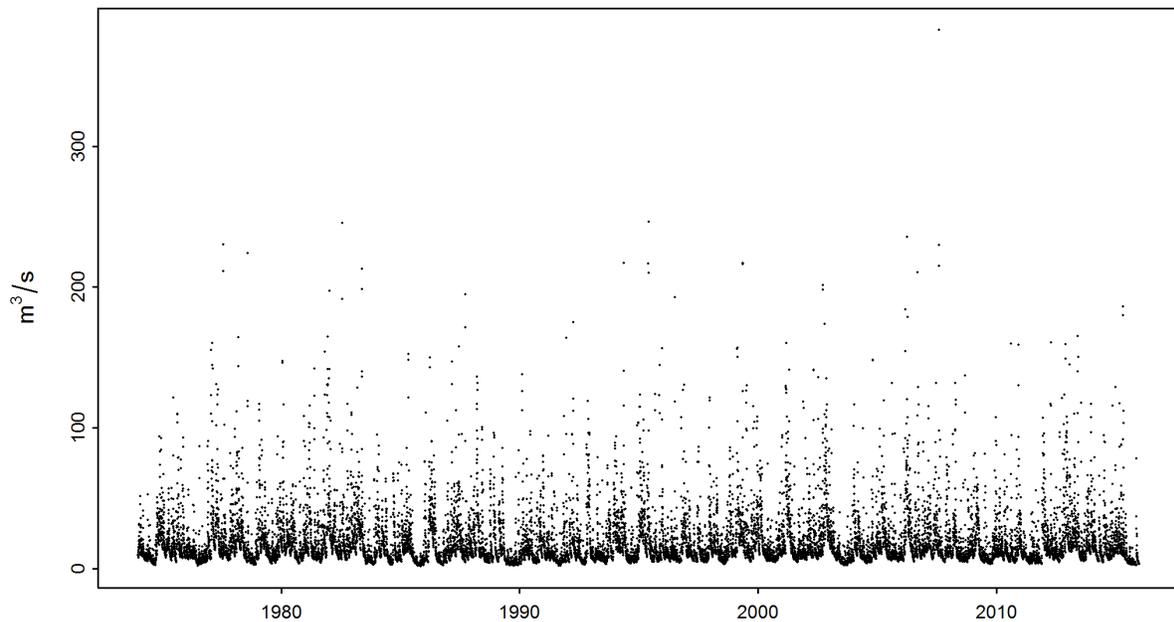
Abbildung 4: Zeitreihe der maximalen Tagesabflüsse [ $\text{m}^3/\text{s}$ ] (01.01.1974 - 31.12.2015)
