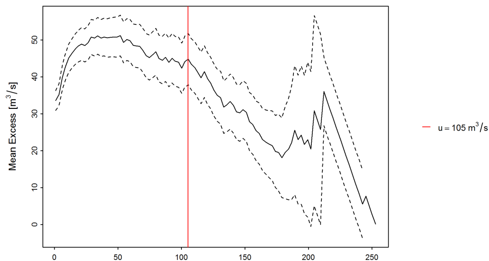
FIGURE 14 – «mean residual life plot» avec le seuil déterminé u (ligne rouge), dépassement moyen (ligne noire), intervalle de confiance à 95 % (traitillés)
