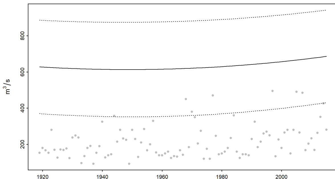
Abbildung 7: Veränderung der mit der Modellvariante „muq“ berechneten HQ 100 (durchgezogene Linien) und des 95%-Konfidenzintervalls (Deltamethode; gestrichelte Linien) über die Jahre 1919-2015
