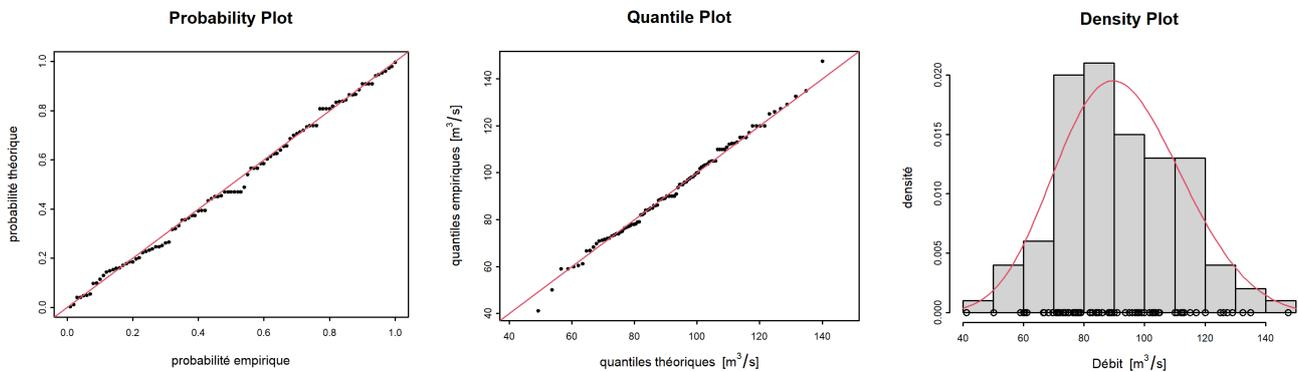
**Probability Plot :** Diagramme comparant les probabilités empiriques aux probabilités théoriques des observations, supposant que celles-ci proviennent de la GEV ajustée. Si l'ajustement était parfait, les points s'aligneraient sur la diagonale (ligne rouge).
