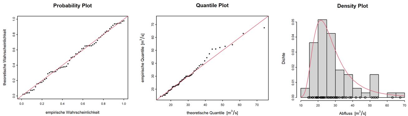
**Probability Plot:** Diagramm der empirischen vs. der theoretischen Wahrscheinlichkeiten. Die theoretischen Wahrscheinlichkeiten werden mit der modellierten GEV geschätzt. Würden die Punkte auf der Diagonalen (rote Linie) liegen, wäre der Fit perfekt.
